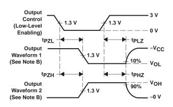
**VOLTAGE WAVEFORMS** PROPAGATION DELAY AND OUTPUT RISE AND FALL TIMES
